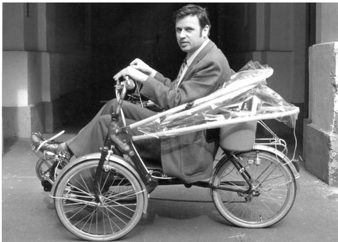
Fahrzeuge wie der Sportmuscar sind sehr aufwendig und teuer in der Konstruktion und Herstellung gewesen und gerieten deshalb relativ schwer. Als Antwort darauf habe ich aus zwei alten Klapprädern und einem defekten Bürostuhl und ca. zwei Meter Rohr (50 x 1 mm) das Muscabrio schweißen lassen. Drei Rohre aus Kunststoff, mittels Heißluft gebogen und mit Folie bespannt, ergaben den
