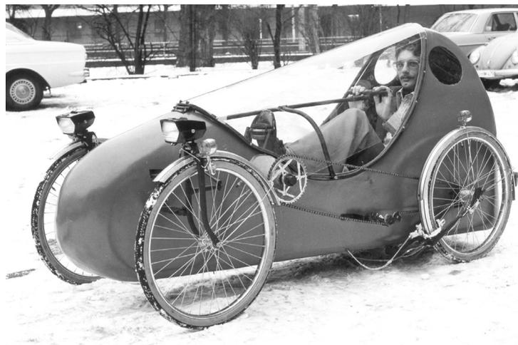
Sportmuscar mit selbsttragender Monocoque-Karosserie aus GFK (bis heute einmalig?). Die Festigkeitsberechnung von faserverstärkten Kunststoffen ist kompliziert und wurde von Ulrich Henke im WS 1975/76 über Versuche durchgeführt. Radführung und Federung vorne an doppelten Blattfedern aus Holz, hinten Längslenker mit Drehstabfederung. Die Lenkung klappt mit der Haube beim Öffnen nach oben.
