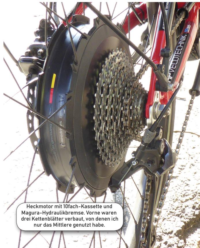
Heckmotor mit 10fach-Kassette und Magura-Hydraulikbremse. Vorne waren drei Kettenblätter verbaut, von denen ich nur das Mittlere genutzt habe.
