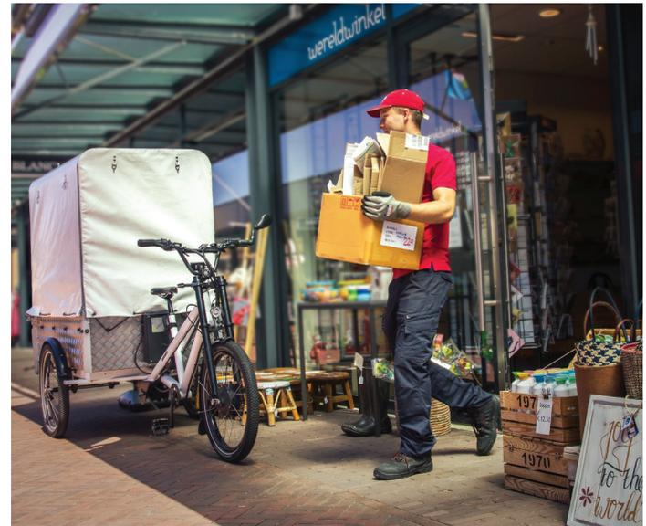
württembergischen Manufaktur Radkutsche, das 2008 erstmals auf der SPEZI stand. Seine dreirädrige Konstruktion sorgt für sicheren Stand und stabile Fahrt auch bei geringen Geschwindigkeiten. Satte 300 Kilogramm Gesamtgewicht gibt der Hersteller für das rund 70 Kilogramm schwere Vehikel frei und deckt damit zusammen mit verschiedenen modularen Aufbauten auch unterschiedlichste kommerzielle Einsatzmöglichkeiten ab.
