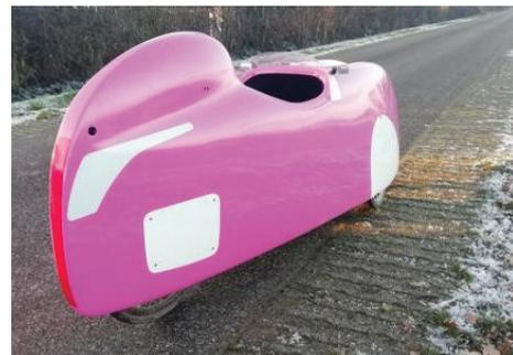
Es fällt vor allem durch die 16“-Räder und die abnehmbaren „Hosen“ auf. Kleine Räder benötigen weniger Platz in den Radkästen und sind leichter und stabiler als die sonst üblichen 20“-Räder. Der Wendkreis ist dadurch bei montierten Hosen nicht größer als beim DF mit offenen Radkästen. Intercity-Bikes sagt auf der Homepage, dass auch ein Ersatzrad mitgenommen werden kann. Der Preis ist mit 9.800 € der gleiche wie der des DF.
